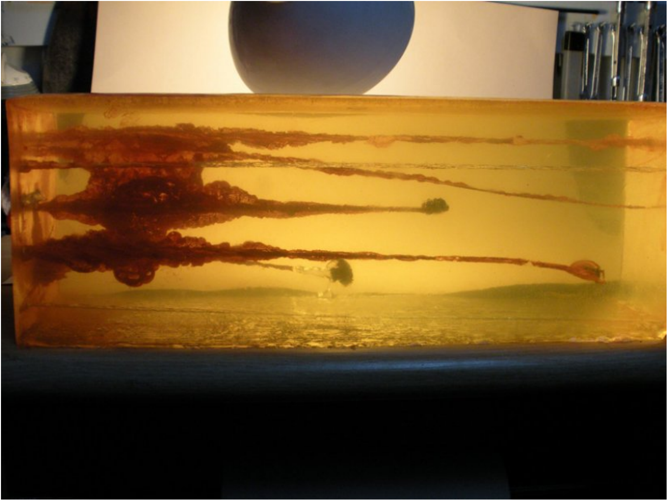
Inspección de cavidades permanentes mediante inyección de agua tintada en el canal de la herida balística.
